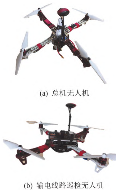
图1 本文组装的四旋翼无人机 Fig. 1 Schematic diagram of UAV assembled
