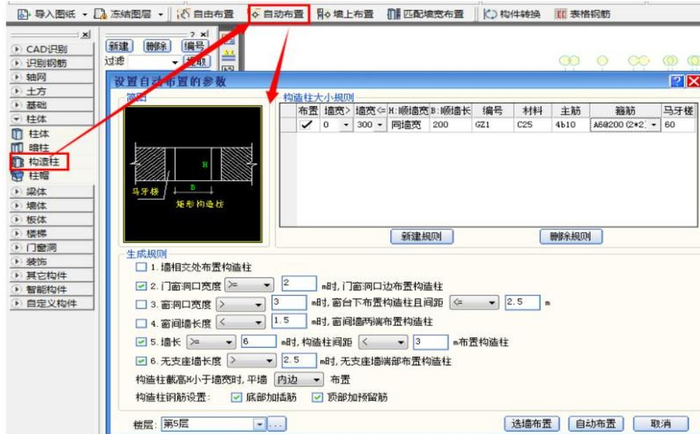
1、构造柱是“标准构件”之一，可以将所有楼层一次性全部计算完成。具体方法是在其布置窗口时全选所有楼层。2、建立构造柱编号时，不需据截面尺寸定义多个编号。软件将自动据墙体厚度改变构件尺寸。
