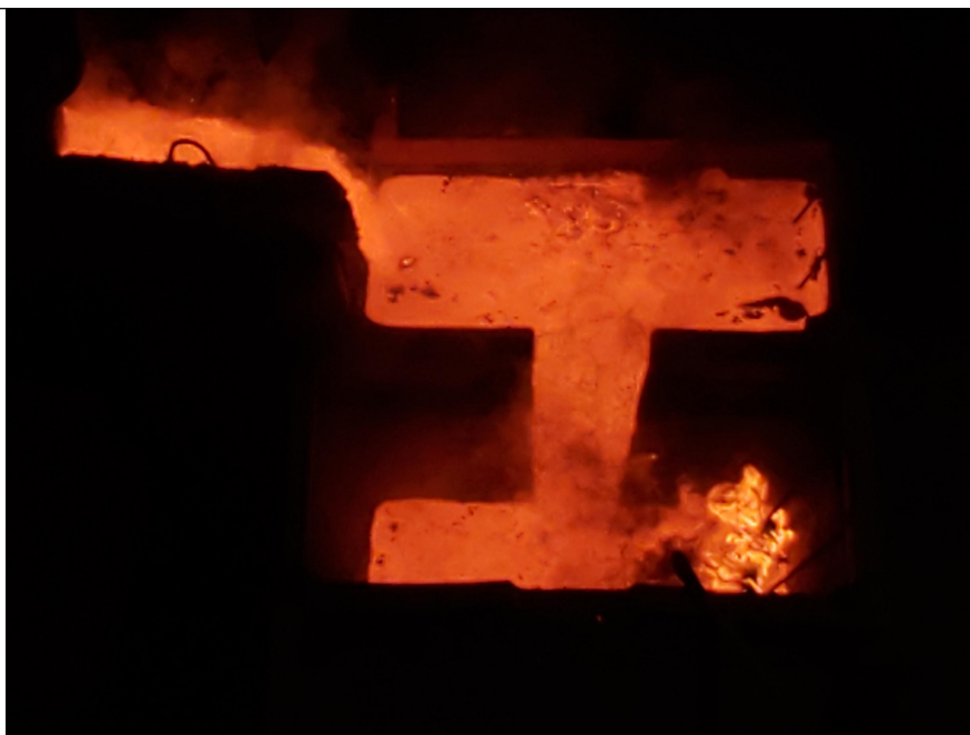
图 2: 出铜口形成粗铜锭
